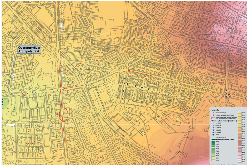
Figuur 10.4 Resultaten berekening water op straat bij vier verschillende rekenmodellen.
